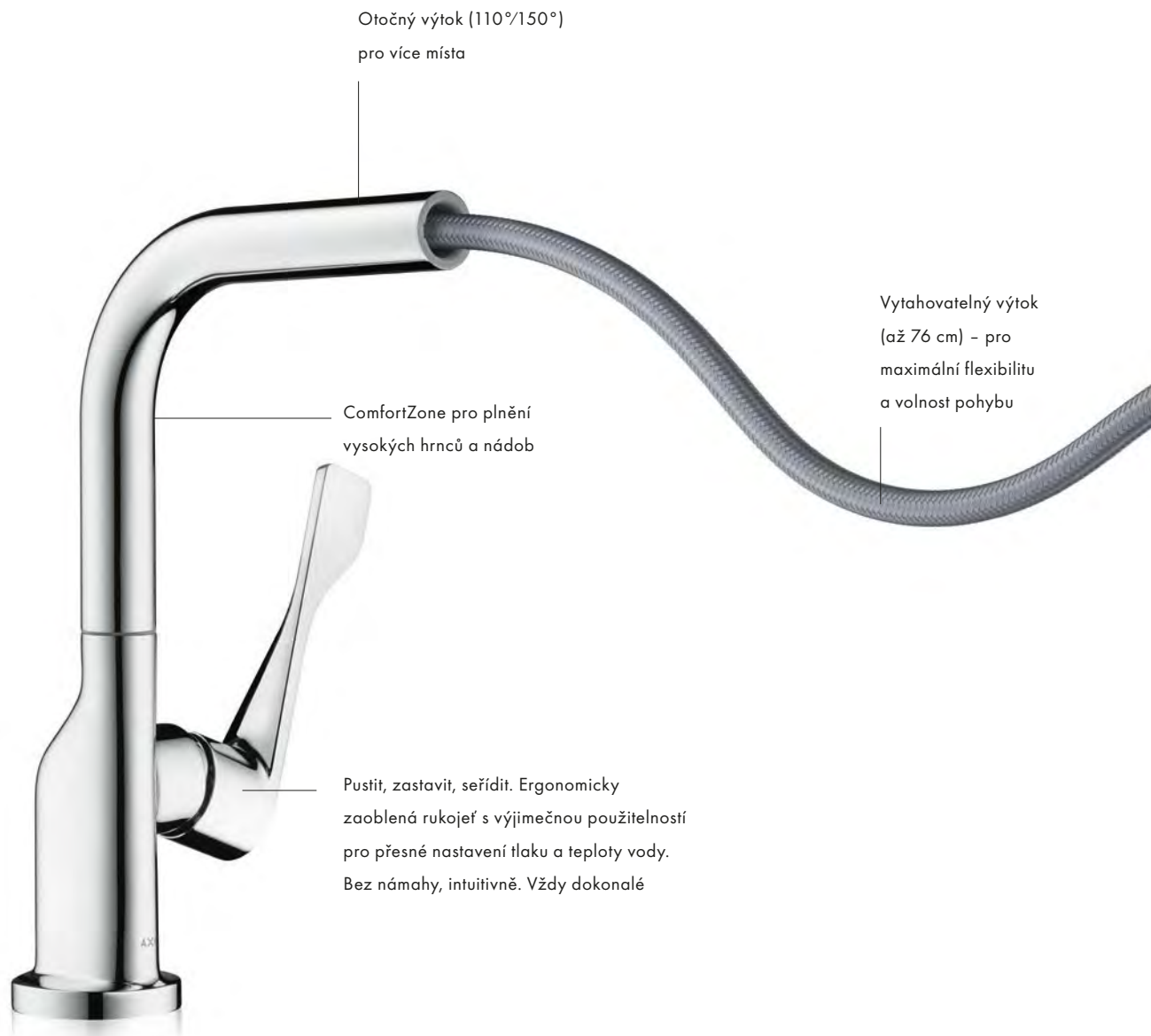
Kuchyňská páková baterie Select 230 2jet s vytahovatelnou sprškou
